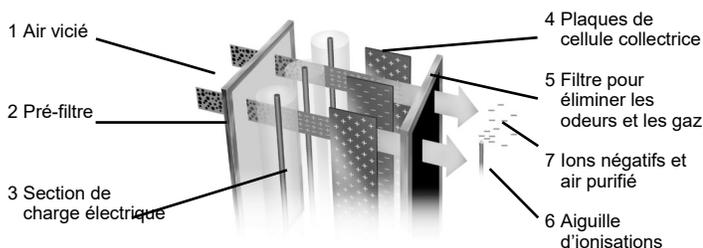
L'air vicié est attiré dans la grille à l'avant et passe par un système de filtrage à 4 étapes.
